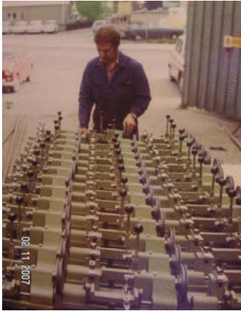
Nyckelfräsmaskiner för fräsning av s.k. tillhållarnycklar var en stor produkt på Gösta Forslunds tid som ägare till firma Pettersson & Barr. Bilden ovan.
