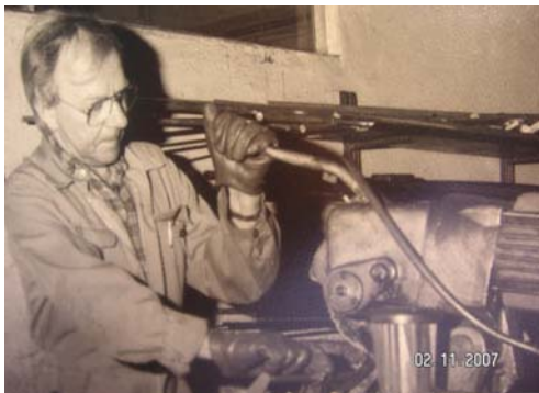
Maskinen på bilden ovan är en PEBA plåtdrivningsmaskin, som Pettersson & Barr tillverkade cirka 100-talet av.
